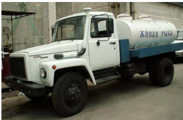
Рис. 34. Автоцистерна АЦТП-2,8 смонтирована на шасси автомобиля ГАЗ-53А6
